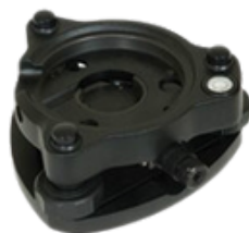
Base Nivelante de Estilo Europeo con Plomada óptica. Enfoque giratorio de 2X, nivel burbuja de 8 min, centrado forzoso y base 5/8 x 11. Rango de enfoque 0.3 m a 15 m y exactitud de 0.5 mm por 1.5 m
