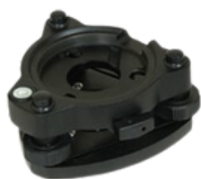
Base Nivelante con Plomada óptica. Enfoque giratorio de 2.5 X. nivel de burbuja de 8 min, centrado forzoso de tres anclajes y base 5/8 x 11. Rango de enfoque de 0.5 a 15 m
