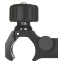
Soporte para Bastón. Hecho de aluminio anodizado, se adapta a un diámetro de jalón de 32 mm, se puede utilizar en un jalón de 25.4 mm a 31.75 mm (con adaptador delrin D11145)
