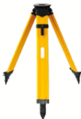
Trípode de Madera, con Doble Bloqueo, Serie Contractor. Cabezal redondo de 165 mm, herrajes de metal, zapata de aluminio con puntas de acero, tornillo 5/8 x 11, incluye correa de hombro
